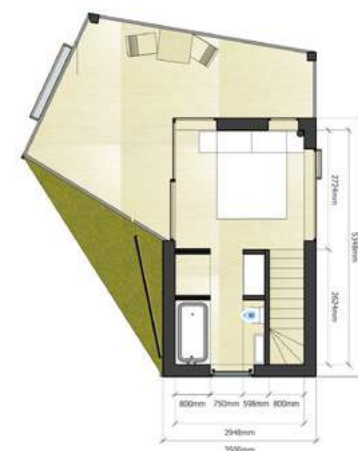
eerste verdieping voorbeeldplattegrond
